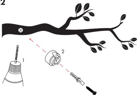
Effettuare il foro  $\varnothing 6$  e fissare la prima parte del passacavo
